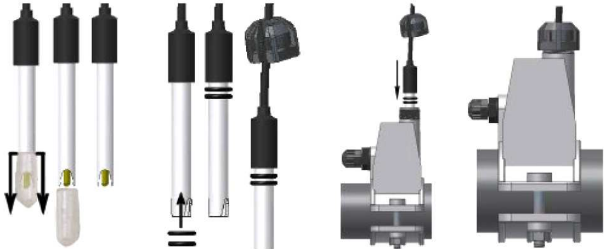
Fig. 3 – Montage de la sonde dans le porte-sonde
